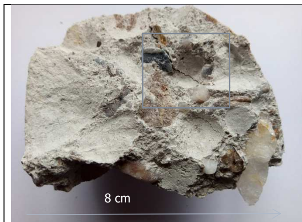
Figure 5 : échantillon 1179-I : fragment de la carotte I permettant de voir le déchaussement des granulats dû à l'obtention de la cassure fraîche et une fissuration.
