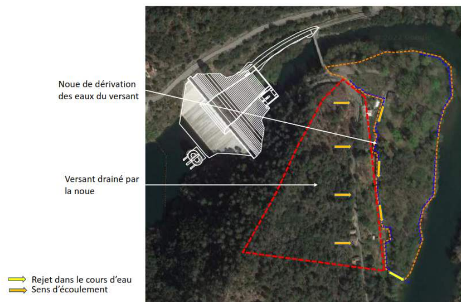
Figure 20 : Versant drainé par la noue de dérivation
