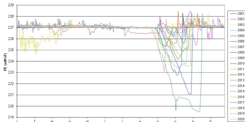
Gestion hydraulique du barrage des Cambous cote deversoir : 227 mNGF
