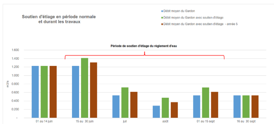
Figure 13 : Évolution du soutien d'étiage dans une année hydrologique normale durant les travaux de l'année 5
