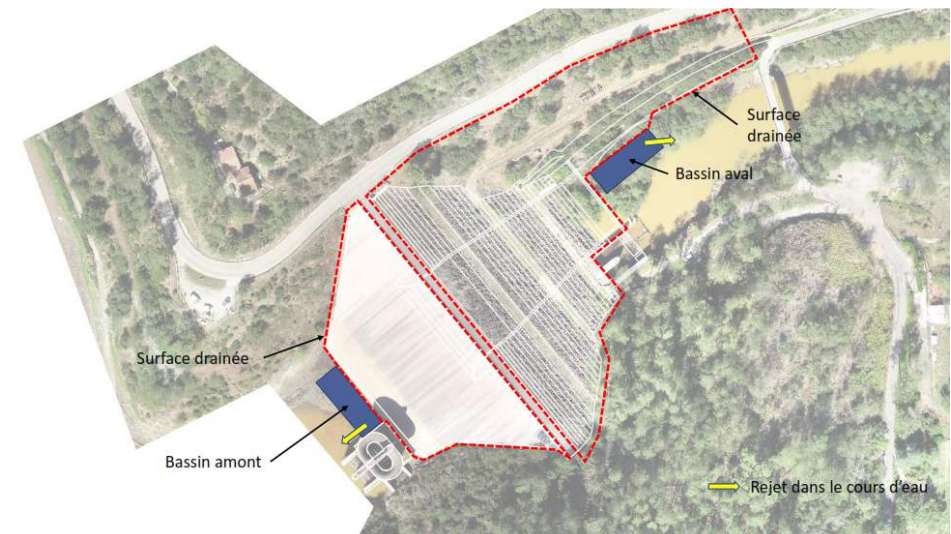
Figure 18 : Implantation des bassins sur le site du barrage de Sainte-Cécile-d'Andorge et surface drainée
