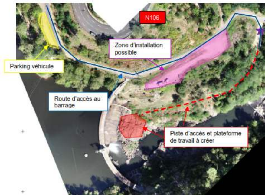
Figure 3 : Installation de chantier au droit du barrage des Cambous
