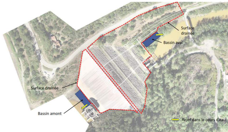
Figure 7 : Implantation des bassins sur le site du barrage de Sainte-Cécile d'Andorge et surface drainée
