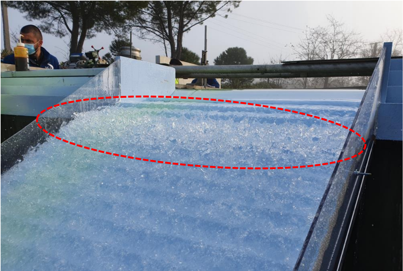
Figure 123 : Zone de décollement pour Q1000 (1/2)
