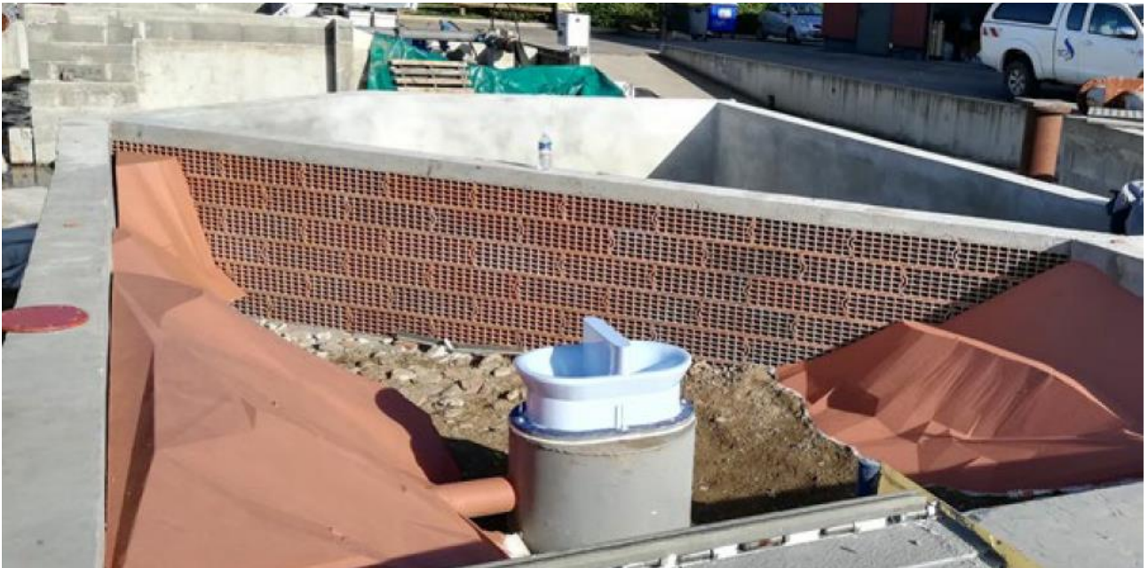
Figure 99 : Parties amont du modèle physique (bassin tranquilisateur, paroi ajourée et retenue)
