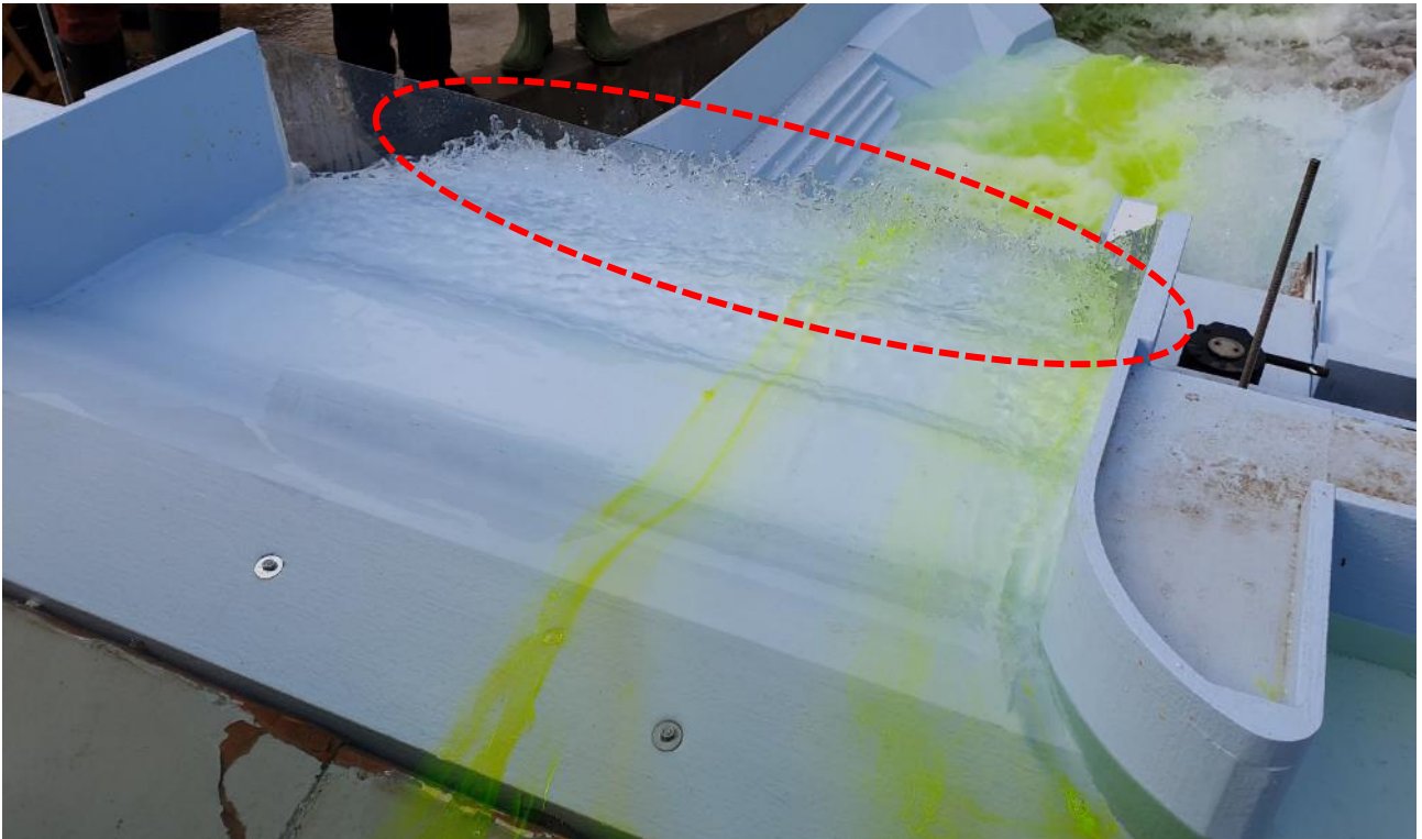
Figure 124 : Zone de décollement pour Q1000 (2/2)
