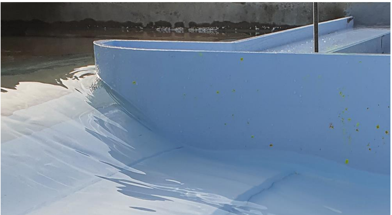
Figure 109 : Conditions des écoulements à l'entonnement sur le modèle du projet (bajoyer rive gauche – Q10 000)
