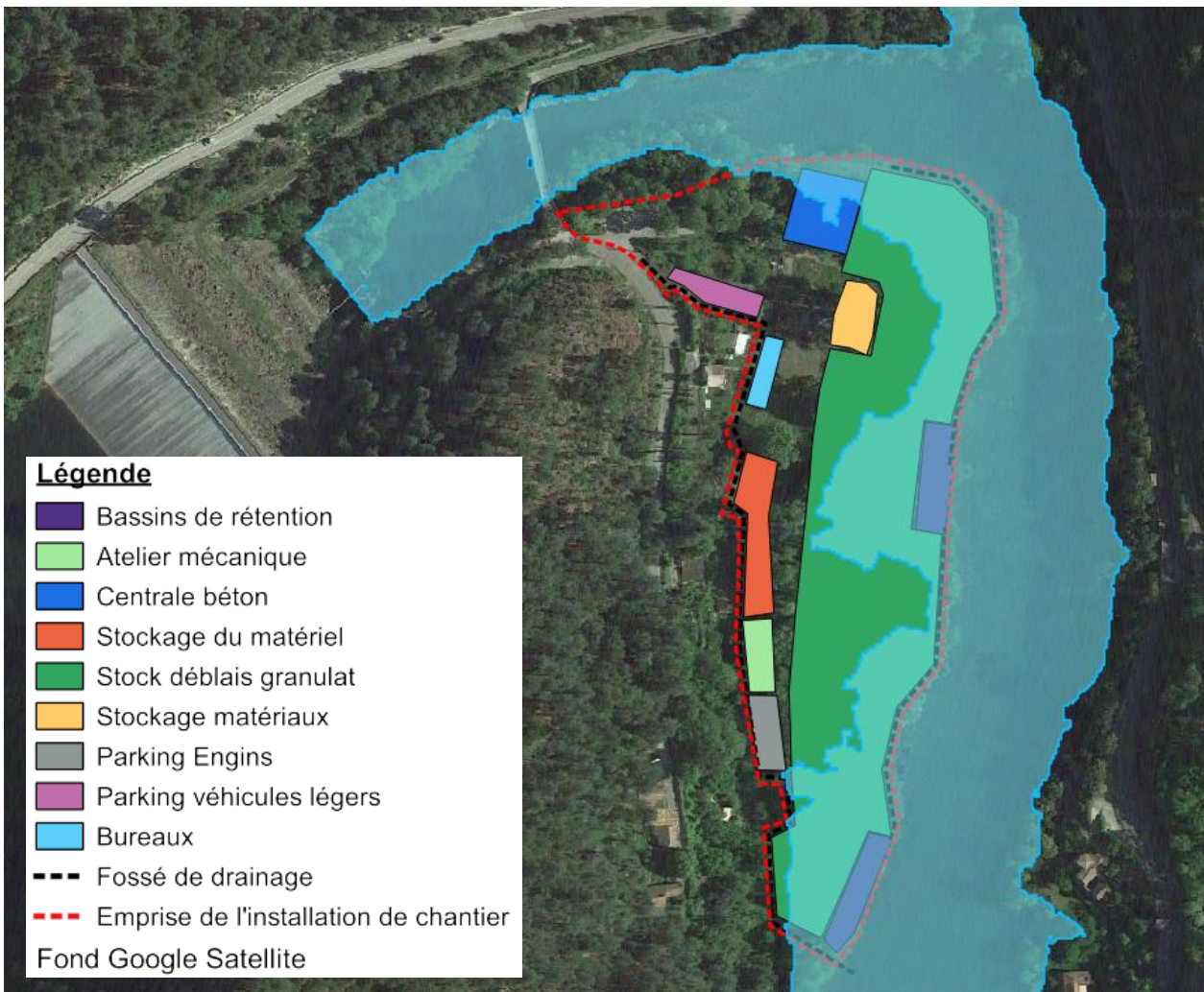
Figure 183 : Emprise de la crue centennale (bleu – sans prise en compte du stock de déblai) et installations de chantier
