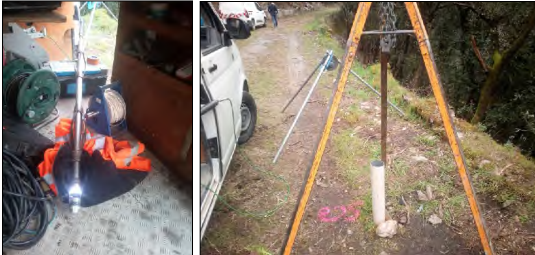
Figure 5 : Photos de l'imageur de paroi et de la mise en station sur le sondage SC8
