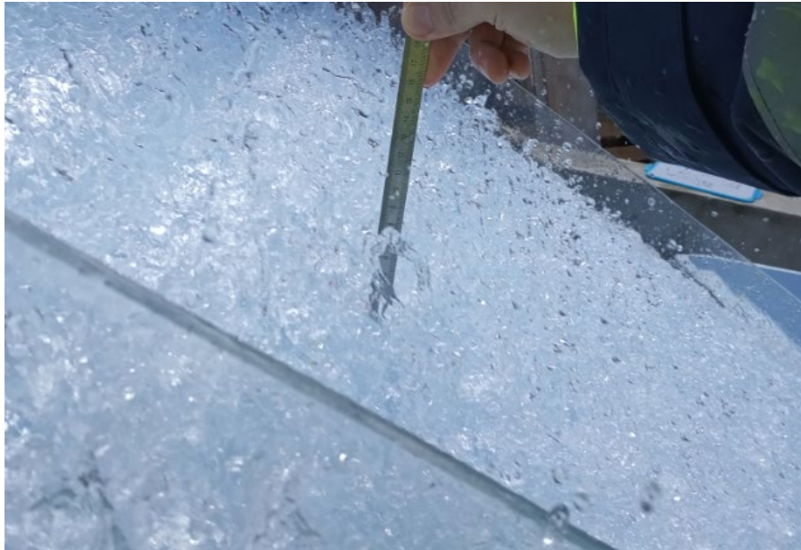
Figure 43 : Mesure de la hauteur d'eau sur le PT 4 pour Q1000
