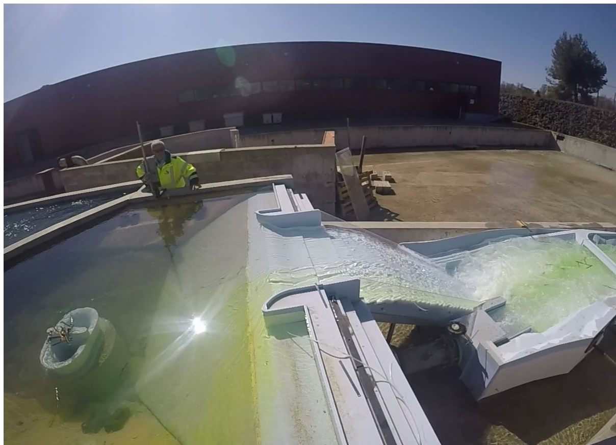
Figure 65 : Essais avec des embâcles venant de la rive droite (Q10 000)
