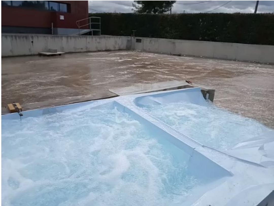
Figure 57 : Mise en charge du pont pour la crue Q100 000
