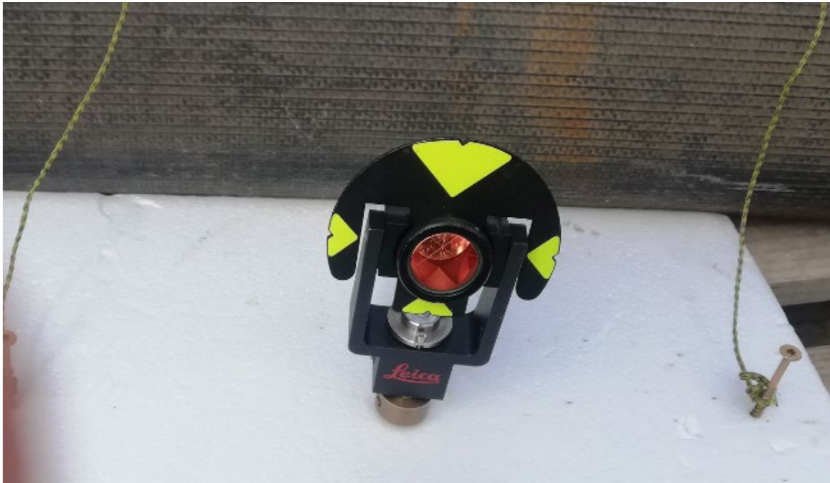
Figure 20 : Flotteur avec prisme utilisé pour vérifier l'horizontalité du plan d'eau
