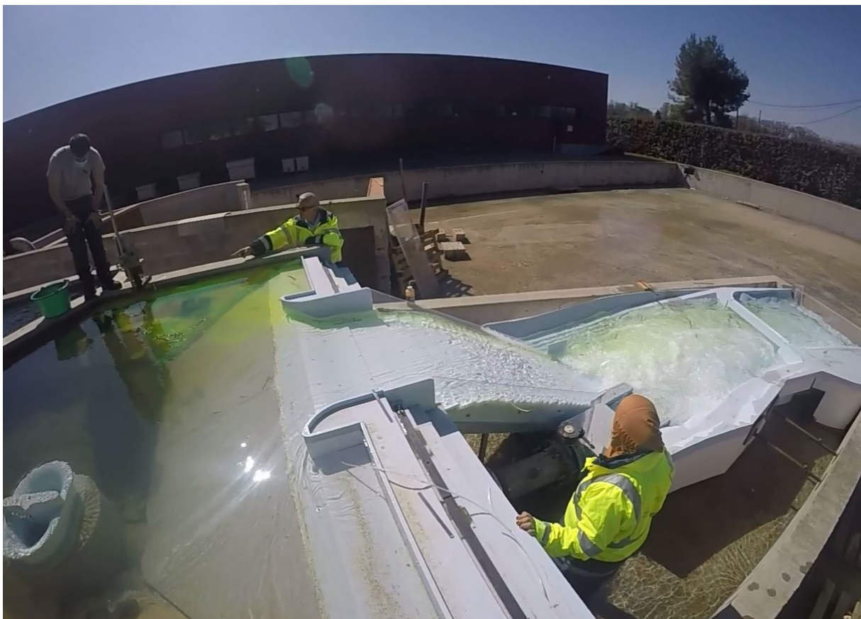
Figure 63 : Essais avec des embâcles venant de la rive gauche (Q10 000)
