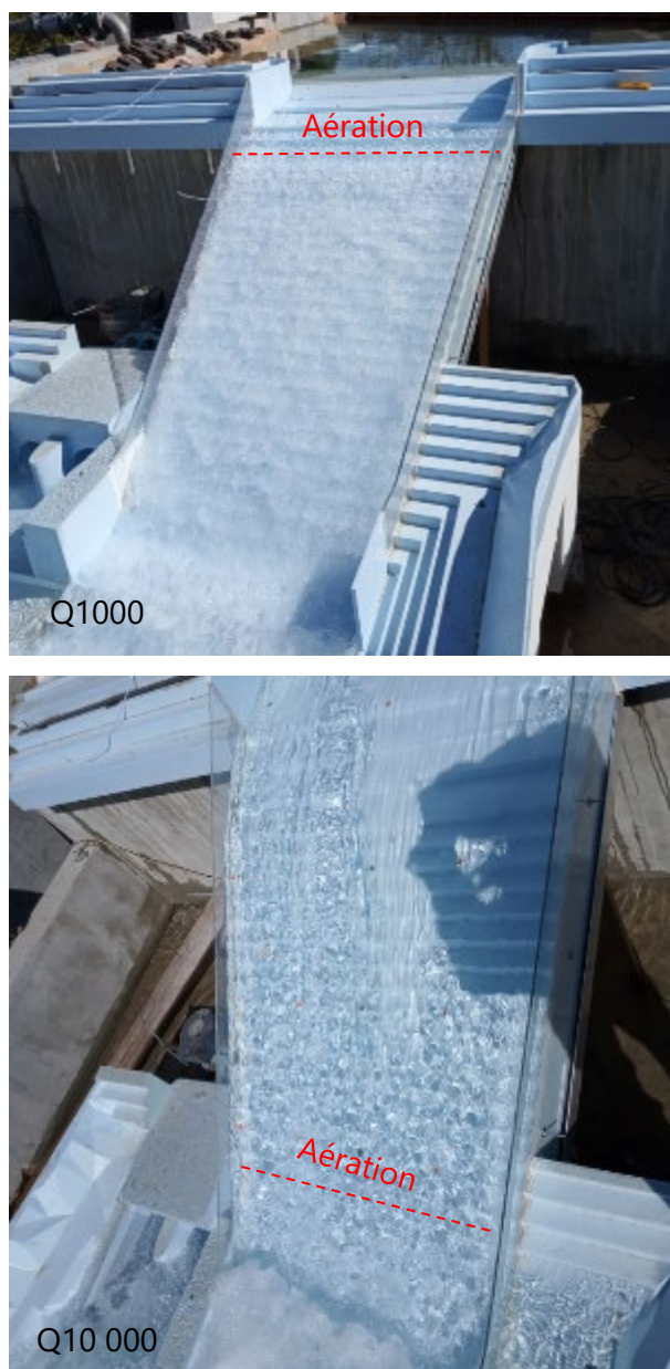
Figure 51 : Zone aérée dans le coursier
