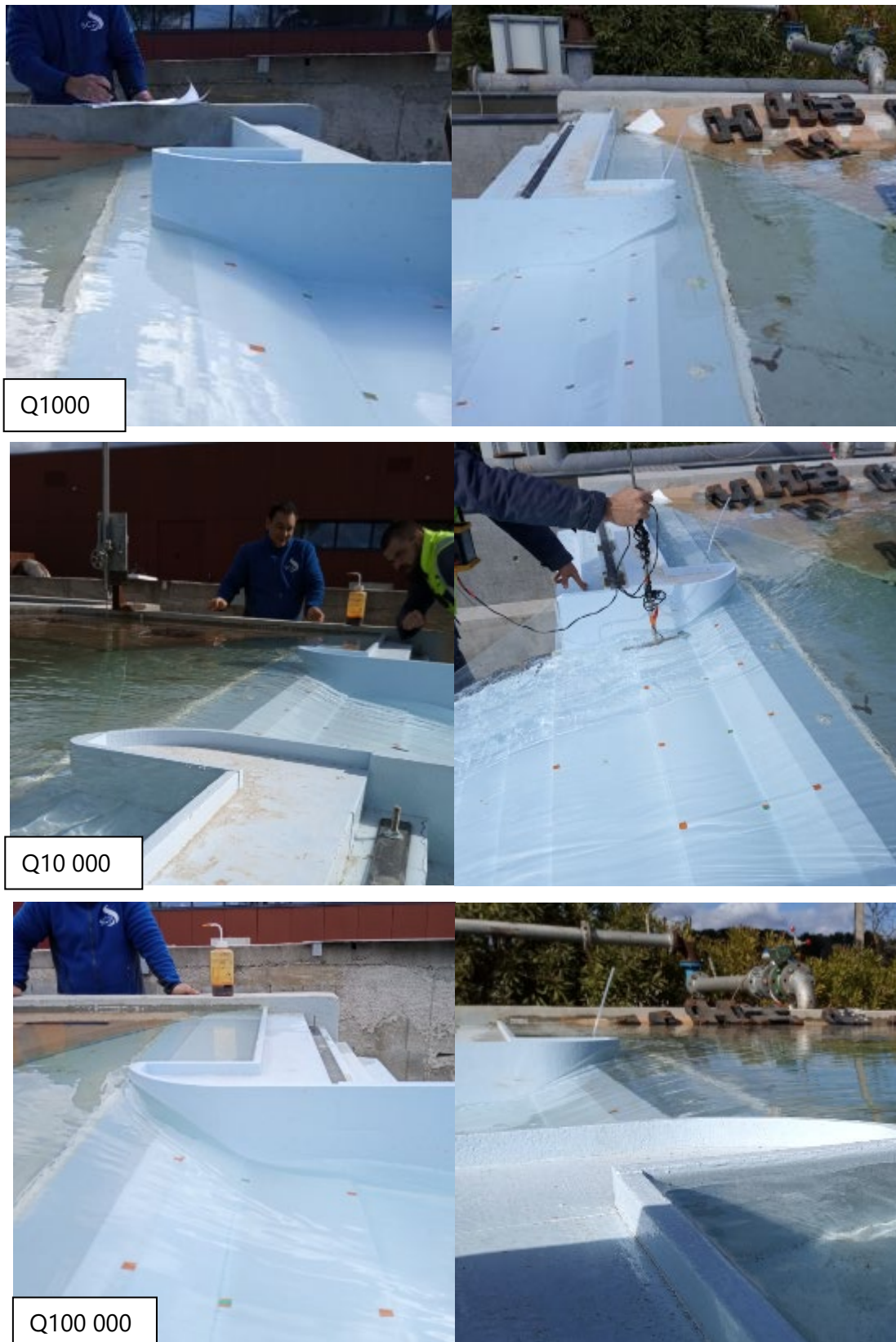
Figure 38 : Photos de l'écoulement dans l'entonnement
